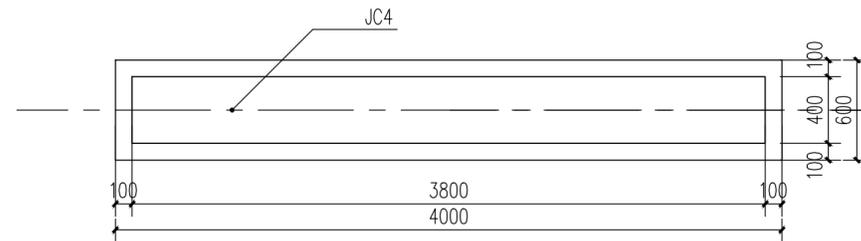
节点九标识基础布置平面图 1:30
